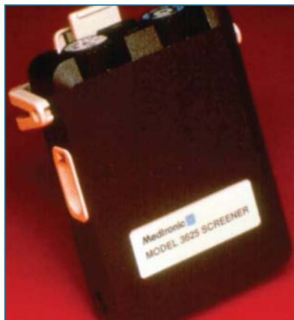
Figura 5. Gerador externo Meditronic (Minneapolis – EUA) para teste
